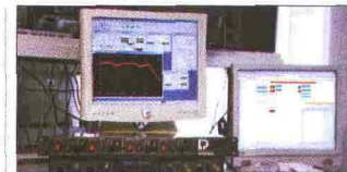
Il sistema metrologico Audio Precision System Two rileva perfino le minime variazioni di volume su tutto lo spettro, come anche le distorsioni audio
